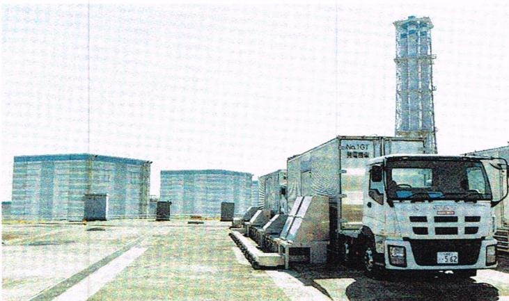
廃炉が決まった福島第2原発。構内の高台には緊急時に燃料を冷やすための発電機車が常時待機する
