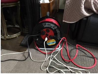
(室内中央へドラム本体を設置しコンセントで屋内配線)
